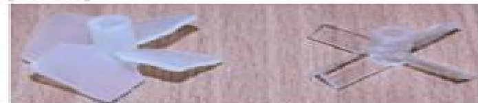
Abb. 2: 3D-gedruckte Rührer, Labor TC, HSNR
